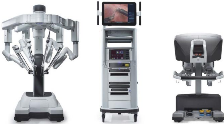
Fig. 1 – Sistema robotico da Vinci Xi, costituito da carrello paziente (a sinistra), carrello visione (al centro) e console del chirurgo (a destra).
